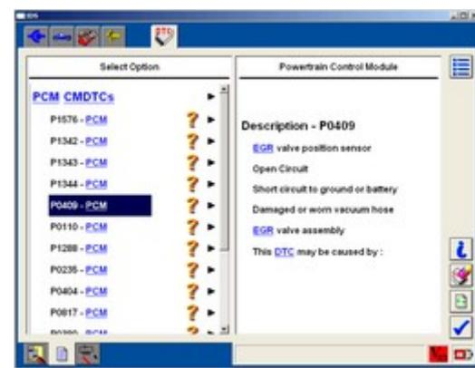
Funkce čtení chybových kódů funguje obdobně jako v IDS, jsou vyčteny nebo vymazány všechny CMOTC (Continuous Memory Diagnostic Trouble Codes) z řídicí jednotky.
