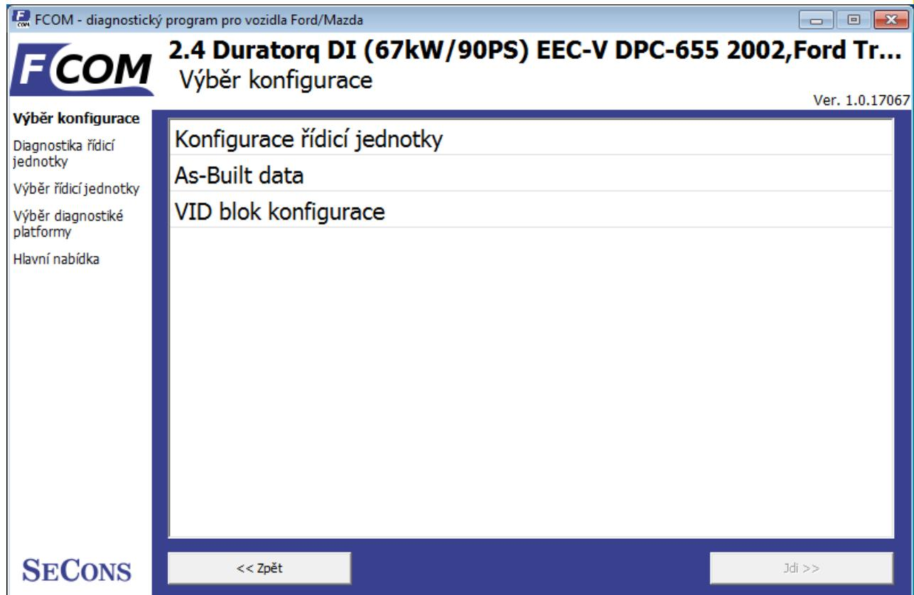
**!** Čtení/zápis konfigurace může vyžadovat aktivaci režimu flash programování řídící jednotky. To může mít za následek chybové kódy související s CAN-BUS/FlexRay komunikací v dalších řídících jednotkách. Může se stát, že se rozsvítí nějaká kontrolka. Po provedení jakékoli konfigurace řídící jednotky doporučujeme provést autoscan. Chyby jako: *BCM: žádná odpověď, VDCM: neplatná přijatá data atd.* lze bezpečně vymazat a neměly by se znova objevit.
