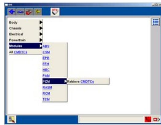
Hlavním rozdílem mezi konceptem programu FCOM a systému IDS je uživatelský přístup k vozidlu a jeho systémům. IDS používá tzv. funkční systém, kdy nejprve zvolíte funkci (např. čtení paměti závad) a následně řídicí jednotku (např. PCM), na rozdíl od FCOMu, kdy nejprve provedete spojení s řídicí jednotkou a následně volíte funkce.
