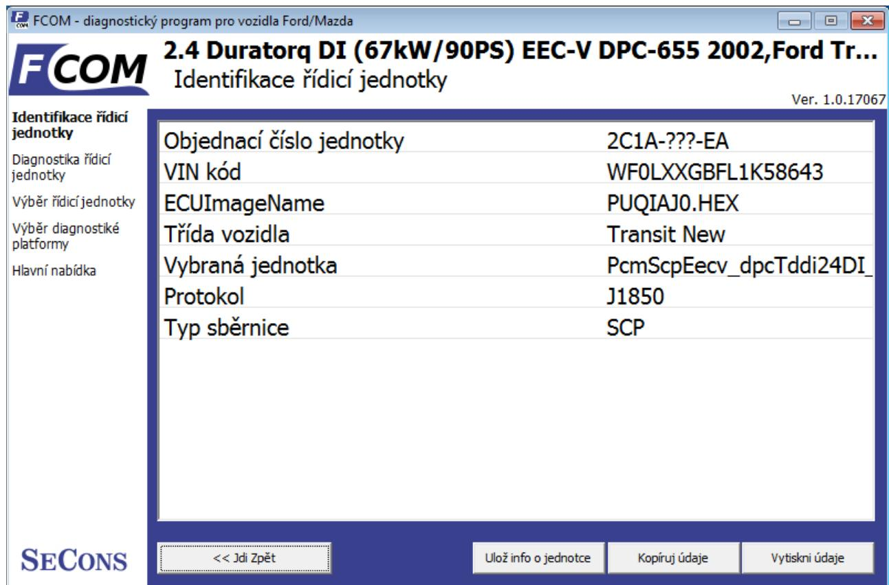
Každá řídicí jednotka by měla obsahovat platný VIN kód. Pokud není VIN kód naprogramován učiňte tak ve funkci *Programování/Kódování jednotky* přístupné z diagnostického menu.
