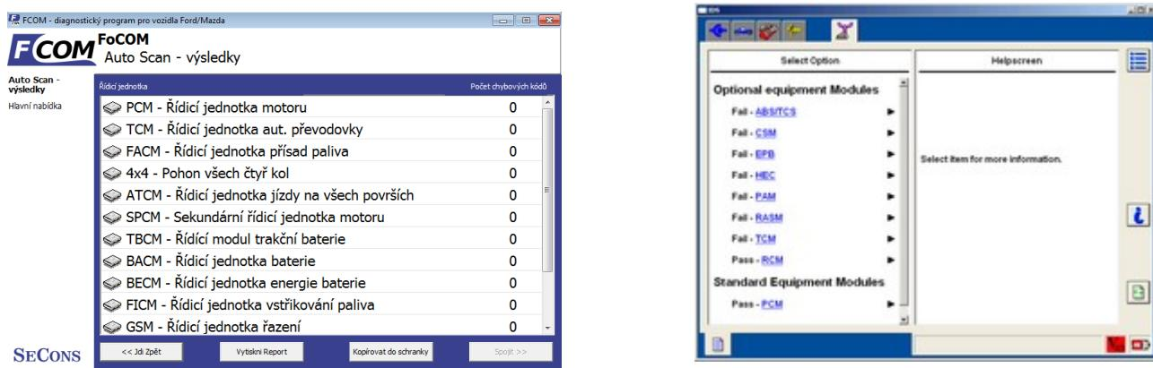
Automatický běh zjistí přítomnost všech dostupných řídicích jednotek, čímž poskytuje funkci testu sítě (Network test). Současně je zobrazen počet chybových kódů v každé řídicí jednotce, což odpovídá funkci vyčtení chyb ze všech řídicích jednotek v systému IDS.
